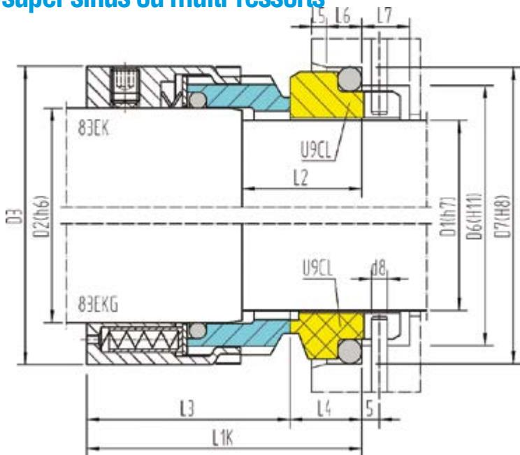
**Garniture mécanique normalisée courte haute pression - Arbre ou chemise avec épaulement
