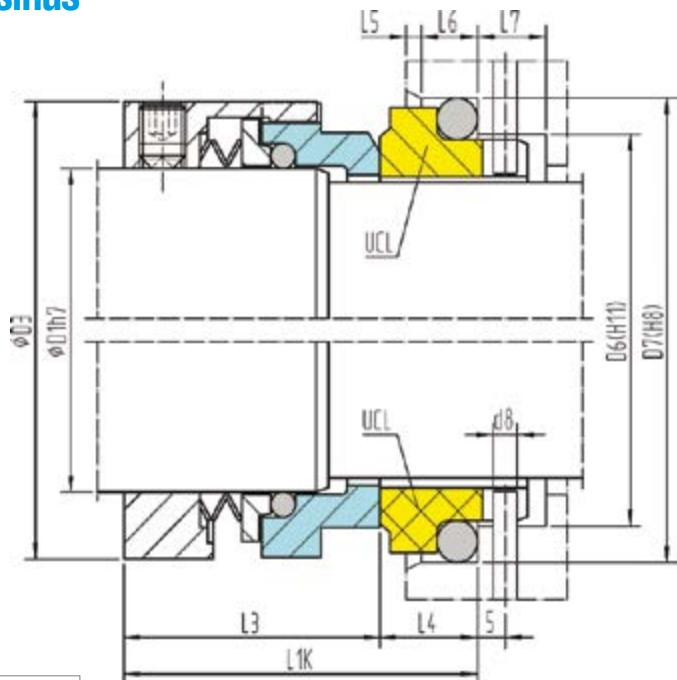
**Garniture mécanique normalisée haute pression - Arbre ou chemise avec épaulement
